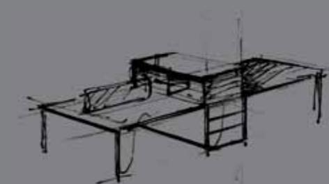
F25 BENCH CON ARMARIO INFERIOR (opcional apoyo pórticos / buc): en este caso la unión de puesto con puesto es por mediación del armario que además de servir de apoyo para la tapa, ejerce de "columna vertebral" del sistema, pudiendo configurar multitud de puestos según las necesidades de cada usuario.
